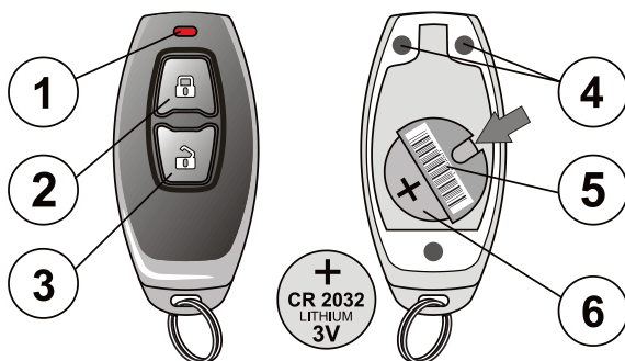
Abbildung: 1 – Signallampe; 2 – Taste zur Sicherung (Ein); 3 – Taste zum Entschirmen (Aus); 4 – Schrauben der unteren Abdeckung; 5 – Seriennummer; 6 – Batterie CR2032 (entfernen Sie die Batterie durch Drücken in Pfeilrichtung).
